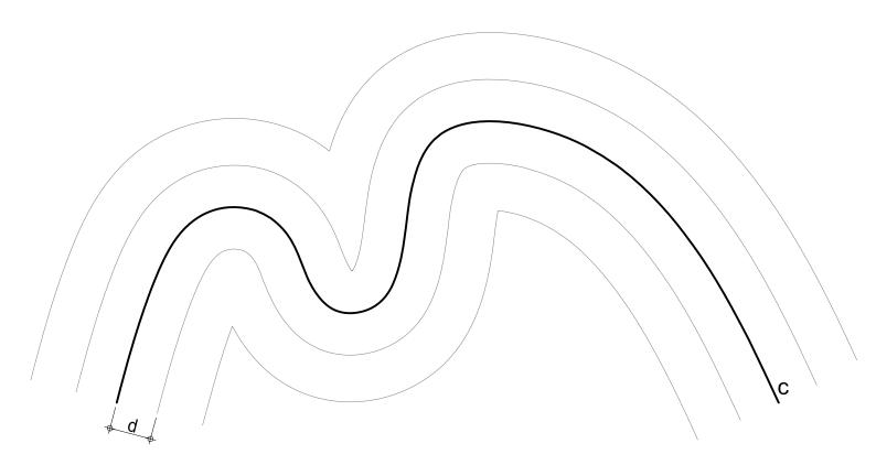
EInführung in Rhinoceros / Übung 2 Konstruktion von Parallelkurven (OFFSET).
