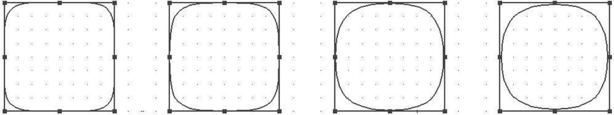
Abbildung 21: B-Spline Kurven zur Kreisannäherung
