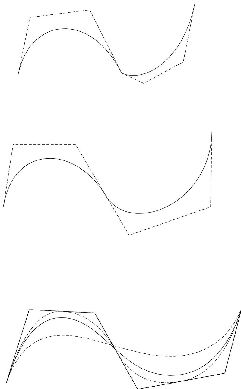
Abbildung 20: B-Spline Kurven
