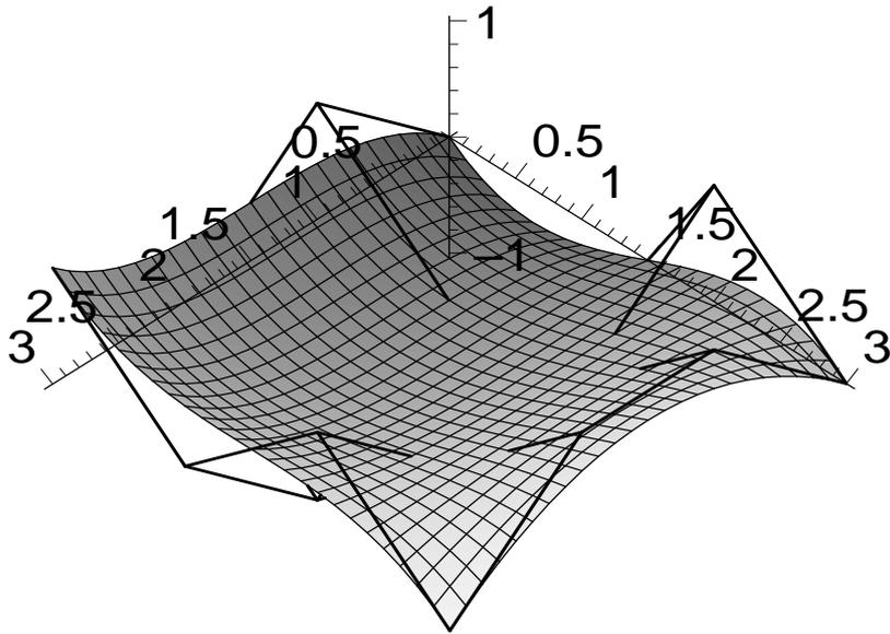
Flächendesign ist nun durch Veränderung der Kontrollstruktur möglich: zum Beispiel der Punkt  $b_{01}$  wird von  $(0,1,-1)$  auf  $(0,1,1)$  verändert:
