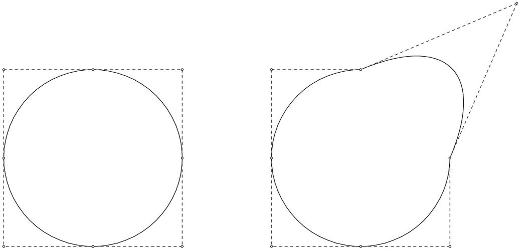
Abbildung 23: Minimale Kontrollpunkte eines KreisNURBS
