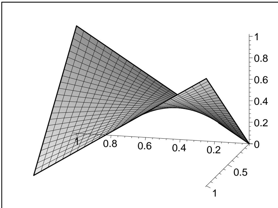
Abbildung 18: Hyperbolisches Paraboloid
